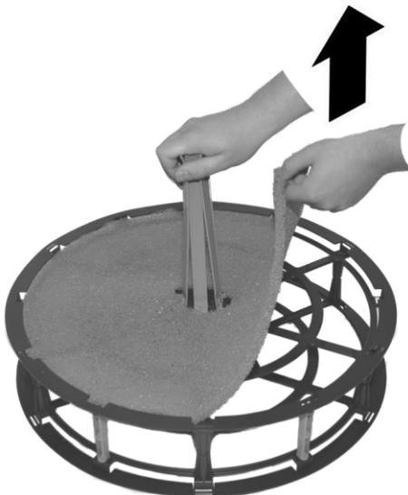
Abb. 24: Inneren Verdunstfilter entfernen
